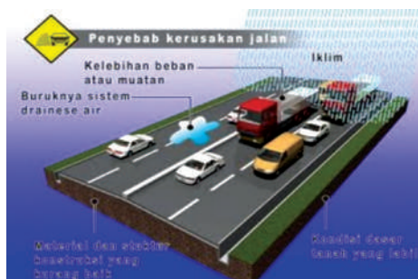
Gambar 3.5. Penyebab Kerusakan Jalan Sumber : Alimoeso, 2009
