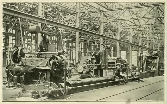
DOUBLE HEAD LOCOMOTIVE FRAME SLOTTING MACHINE.—REMENT, MILES & CO. DRIVEN BY A 20-H.P. MULTIPLE-VOLTAGE CROCKER-WHEELER MOTOR.
