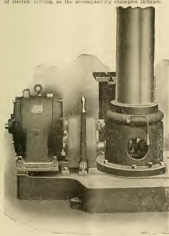
GEARED CONSTANT-SPEED DRIVE (STYLE A) UPON THE NO. 1 RADIAL DRILL,—WESTINGHOUSE INDUCTION MOTOR.
