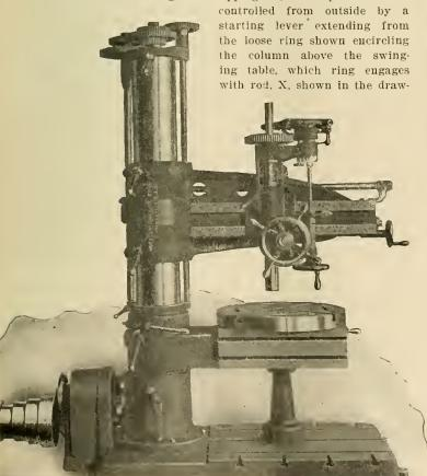
FIG. 48.—GENERAL VIEW OF THE MUELLER RADIAL DRILL.
