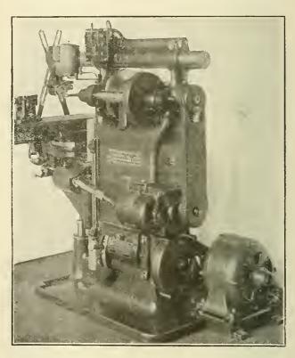
FIG. 2.—CONSTANT-SPEED DRIVE FOR A UNIVERSAL MILLING MA-CHINE USING CHANGE GEARS FOR SPEED CHANGES—BROWN & SHARPE MFO. CO.—GENERAL ELECTRIC MOTOR.
