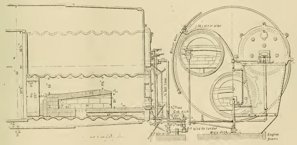
FIREBOX SETTING .- LONG-DISTANCE TEST OF A TRIPLE-FURNACE OIL-BURNING LOCOMOTIVE. ATCHISON, TOPEKA & SANTA FE RAILWAY.
