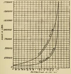
FIG. 3.—RESISTANCE CURVES OF THE WAUGH DRAFT GEAR.
