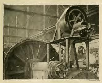
CONSTANT-SPEED MOTOR DRIVE UPON A LARGE BEMENT-MILES WHEEL LATHE.—AN ADAPTATION TO AN OLD TOOL.
