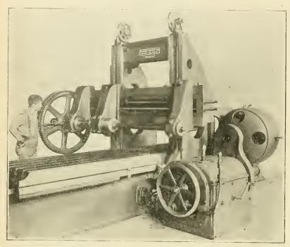
FIG. 11.—VARIABLE-SPEED MOTOR DRIVE, USING GEAR MECHANISM,
