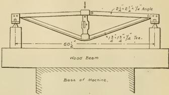
BRAKE BEAM ARRANGED FOR TEST
