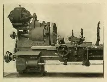
GEARED DRIVE FOR A 24-INCH LATHE.—AMERICAN TOOL WORKS CO.
