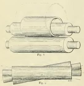
ARRANGEMENT OF SWIVELING ROLLS FOR ROLLING OUT HEAVY TUBES
