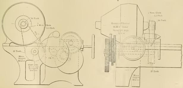
FIG. 17.—ARRANGEMENT OF THE MOTOR SUPPORT BRACKET UPON THE CAR-ANLE LATHE.
