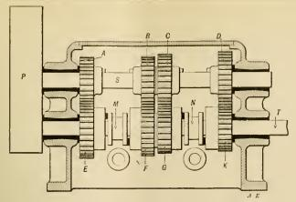
FIG. 23.—LONGITUDINAL SECTION OF THE MAIN DRIVE SPEED NOX.
