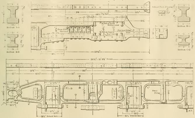
CAST STEEL FRAMES FOR 4-6-0 TYPE LOCOMOTIVE.
