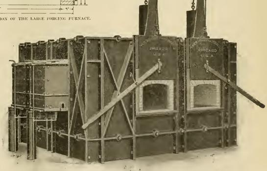
THE LARGE FORGING FURNACE, SERVING THE HEAVY HAMMER IN THE SMITH SHOP.
