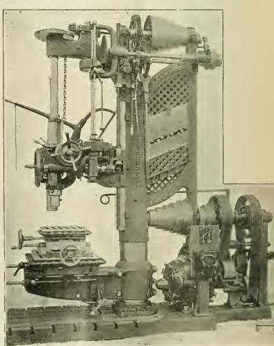
BELTED CONSTANT-SPEED REVERSIBLE DRIVE UPON A 48-IN. UPRIOHT DRILL PRESS.—GOULD & EBERHARDT.
