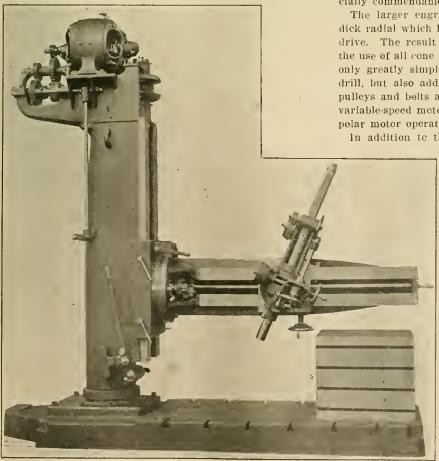
DIRECT-GEARED DRIVE UPON A 6-FT. FULL UNIVERSAL RADIAL DRILL.—FOSDICK MACHINE TOOL COMPANY. GENERAL ELECTRIC VARIABLE-SPEED MOTOR BY FIELD CONTROL.
