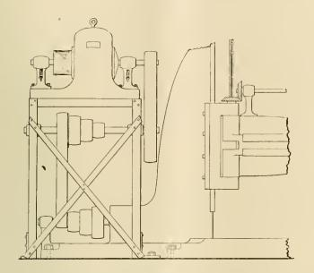
MOTOR AND COUNTERSHAFT SUPPORT USED ON A CONSTANT-SPEED DRIVE FOR A RADIAL DRILL AT THE BALDWIN LOCOMOTIVE WORKS,
