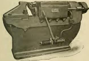
FIG. 4.—HORIZONTAL FLANGE PUNCH.
