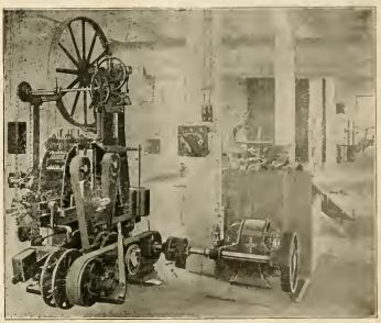
FIG. 2.—BAND RESAW, EQUIPPED WITH A DIRECT-COUPLED DRIVE FROM A 15-II. P. BACK-GEARED MOTOR.
