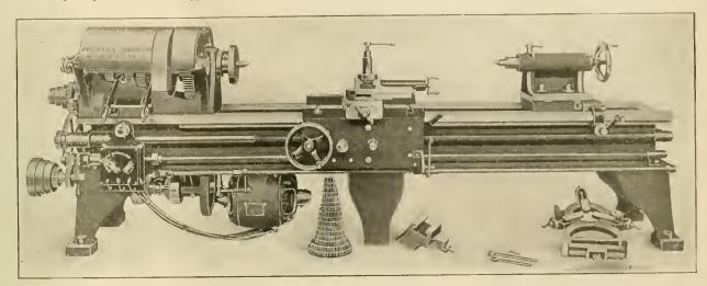
CONSTANT-SPEED GEARED DRIVE ON A 26-IN. PRENTICE LATHE. -- PRENTICE BROS. COMPANY.
