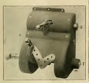
FIG. 32.—EXTERIOR VIEW OF 16-SPEED FEED GEAR BOX.
