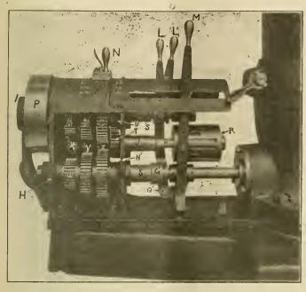
42.—INTERIOR VIEW OF SPEED BOX, SHOWING SLOTTED CON-TROLLING DRUM.
