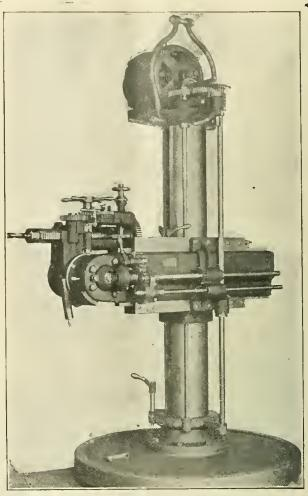
NOVEL DIRECT-GEARED DRIVE (BULLOCK MOTOR) UPON A SPECIAL PORTABLE RADIAL DRILL.—ROOS & MILL.
