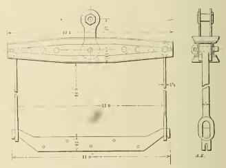
DETAILS OF A DOX-GIRDER BEAM AND THE SLINGS.
