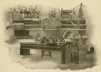
SPECIAL SPIRAL-GEAR DRIVE FOR AMERICAN TOOL COMPANY'S CABINET LATHE.
