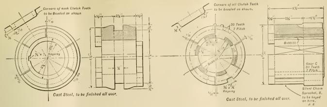
FIG. 5.—DETAILS OF THE DOUBLE JAW STEEL CLUTCH.
