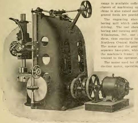
GEARED DRIVE UPON A 51-IN. BOBING MILL.—NILES TOOL WORKS.
