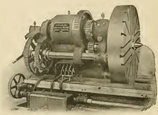
HEADSTOCK DRIVE ON A FITCHBURG LATHE. -- RULLOCK MOTOR.
