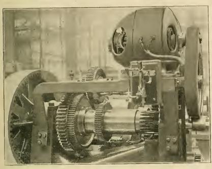
DIRECT DRIVE ON A 2S-INCH POND ENGINE LATHE.
