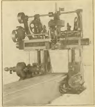
FIG. 9.—THE 42-INCH COMBINED HORIZONTAL AND VEBTICAL SPINDLE
