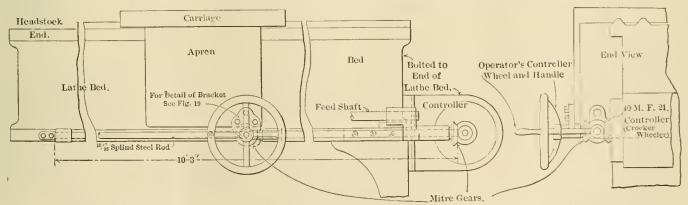
FIO. 20.—THE MOST CONVENIENT ABRANGEMENT FOR THE MOTOR CONTROLLER—CONTROLLER BOLTED TO END OF LATHE BED.
