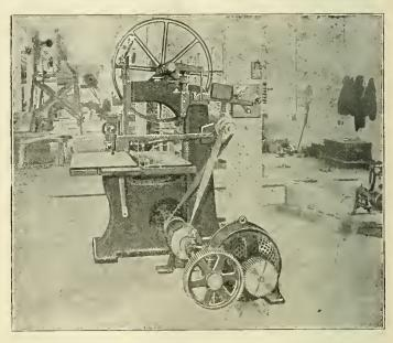
FIG. 6.—DIRECT-COUPLED DRIVE UPON A BAND RESAW,—71/2-H. P. BACK-GEARED MOTOR.
